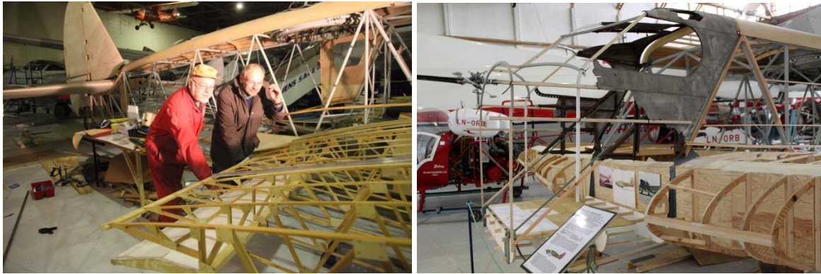
Rasmus Svihus og Kjell Dahle sjekker nylig montert flaps.
