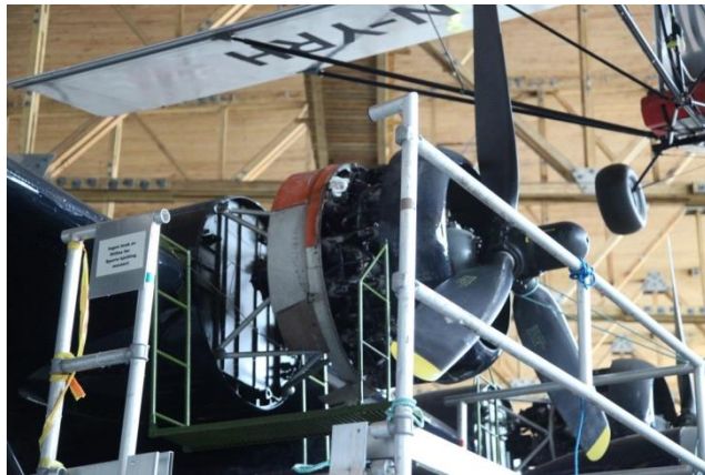
Montering av motordeksler.
