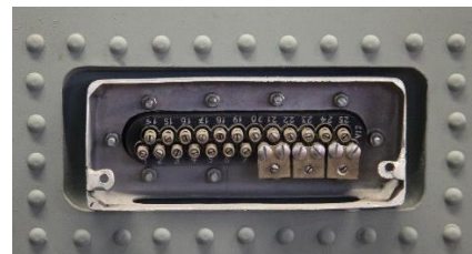
Det er installert et komplett elektrisk anlegg i flyet, deriblant deler av det originale anlegget som er bevart. Bildet til venstre viser noen av de bevarte elektriske komponentene. I midten sikringsboksene under oppbygging. Til høyre trykktette gjennomføringer for de elektriske anleggene mellom cockpiten og resten av flyet.
