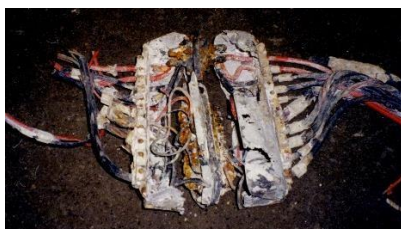
Det er installert et komplett elektrisk anlegg i flyet, deriblant deler av det originale anlegget som er bevart. Bildet til venstre viser noen av de bevarte elektriske komponentene. I midten sikringsboksene under oppbygging. Til høyre trykktette gjennomføringer for de elektriske anleggene mellom cockpiten og resten av flyet.
