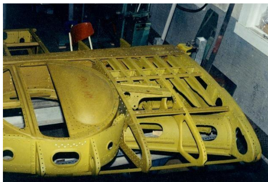
Deler av en ving etter at platene er fjernet, og før gjenoppbyggingen. Til høyre vingen under gjenoppbygging.
