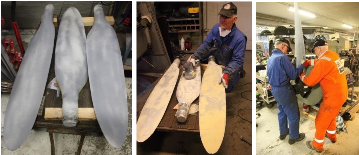
Muséet hadde kun ett originalt propellblad, som ble brukt som mal for å støpe de 3 propellbladene. Til venstre bladene ferdig støpt, i midten pusser Kristian Helland et av bladene, og til høyre prøvemonterer Kristian Helland og Arne Lende det første propellbladet.
