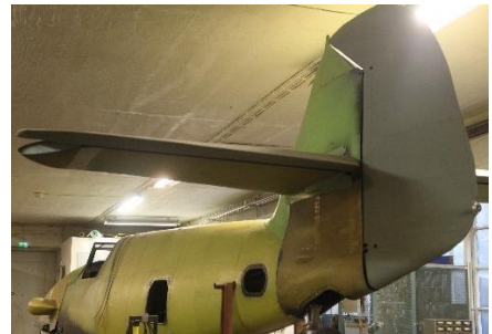
Rasmus Svihus kler rorene med duk, og til høyre ferdig montert.
