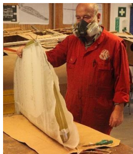
Rasmus Svihus kler rorene med duk, og til høyre ferdig montert.
