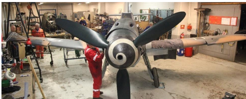
For å tilpasse vingefairingene ble det nødvendig å montere begge vingene på flyet, selv om det førte til at det ble svært trangt i verkstedet i en periode.
