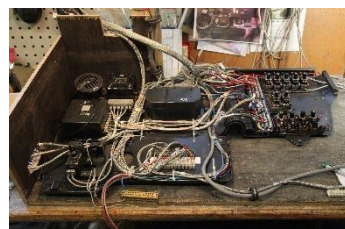
Det er installert et komplett elektrisk anlegg i flyet, deriblant deler av det originale anlegget som er bevart. Bildet til venstre viser noen av de bevarte elektriske komponentene. I midten sikringsboksene under oppbygging. Til høyre trykktette gjennomføringer for de elektriske anleggene mellom cockpiten og resten av flyet.
