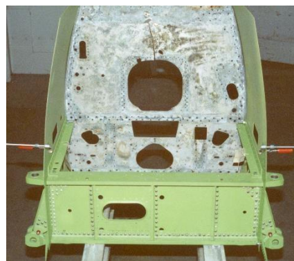
Til venstre brannskott foran cockpit, til høyre det samme skottet delvis restaurert.
