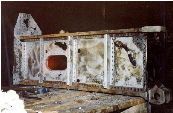
Til venstre vingebjelken før restaurering, til høyre den samme bjelken etter restaurering.
