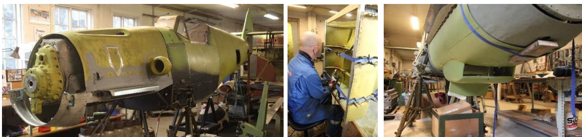
Til venstre blir motordekslene prøvemontert, i midten tilpasning av underdekslet. Dette viste seg ikke å være av korrekt type for vår motor, og gjennom en byttehandel fikk vi et korrekt deksel. På bildet i midten tilpasser Kjell Naas et av dekslene.
